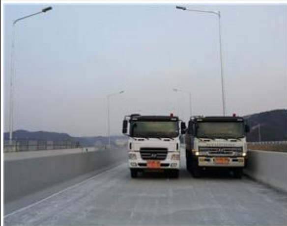
정적 재하시험 전경
